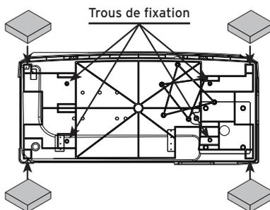
Possibilité de fixer l'appareil au sol, grâce aux trous dans le socle de l'appareil ou à l'aide de rails (non fournis). Il est également possible de fixer l'appareil sur des équerres (non fournies). Un schéma de perçage est disponible au dos du carton d'emballage.
